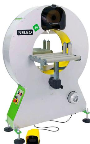
Горизонтальные обмотчики в стрейч пленку NELEO, производство Plasticband SA (Испания). Линейка полуавтоматических горизонтальных обмотчиков для обмотки различной продукции в стрейч пленку.
