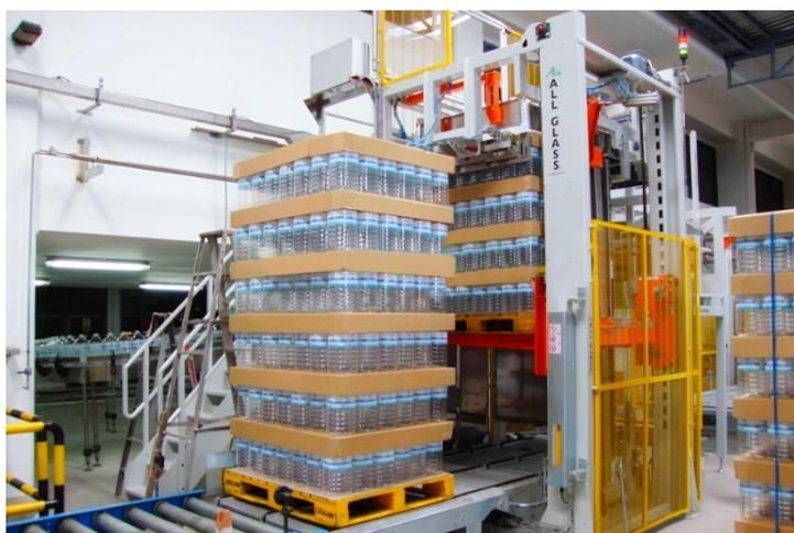
Автоматический депаллетайзер для бутылок и банок с верхней подачей продукции, работает по принципу сдвига слоя с перемещением паллета.
