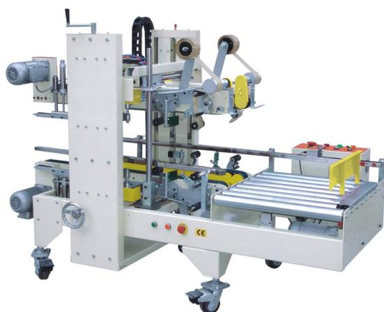
Модель GPG-50 - это полуавтоматический заклещик для углов коробов с верхним и боковыми приводными ремнями. Заклейщик оснащен конвейером, расположенным под углом 90° к приводным ремням, благодаря которому коробки могут приниматься с заклещика верхних и нижних створок коробов на производственной линии. GPG-50 одновременно заклеивает ребра и углы коробов клеевой лентой.
