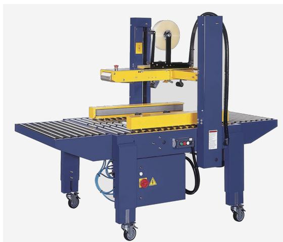
Модель EXC-105SDR производства Extend Great International Corp., Тайвань представляет собой машину для заклейки картонных коробов скотч лентой. Машина EXC-105SDR оснащена двумя заклеивающими устройствами, поэтому может одновременно заклеивать верхние и нижние створки короба лентой шириной 25,5 мм, 30 мм или 50 мм.
