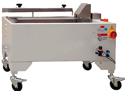
Формующая машина GPK-40S пригодится на любом производстве небольших или средних размеров, использующих в качестве упаковки картонные коробки. Машина раскладывает коробку из заготовки, формируя боковые стенки и дно, благодаря чему снимает часть работы с упаковщика и ускоряет производительность упаковочных работ на производстве. Чаще всего, такая машина используется вместе с заклейщиком гофрокоробов.
