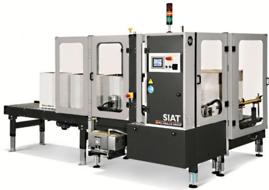
Серия F346 представляет собой высокоскоростные автоматические формовщики и заклейщики коробов с производительностью до 18 коробов в минуту. Производство компании Siat, Италия. Модели данной серии отличаются по размерам коробов, с которыми они работают. Данные машины формируют короба из стандартных заготовок и заклеивают нижние створки короба лентой скотч. Автоматический формовщик гофрокоробов F346 предназначен для интеграции в высокопроизводительные автоматические упаковочные линии.
