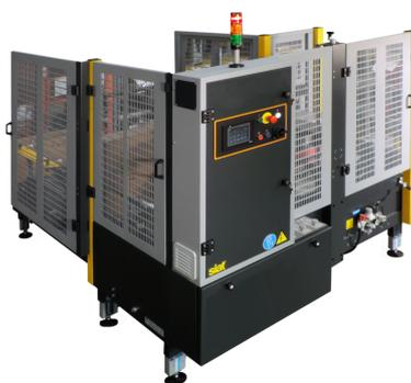
Серия F344-4 представляет собой высокоскоростные автоматические формовщики и заклейщики коробов с производительностью до 18 коробов в минуту. Производство компании Siat, Италия. Модели данной серии отличаются по размерам коробов, с которыми они работают. Данные машины формируют коробки из стандартных заготовок и заклеивают нижние створки короба лентой скотч. Автоматический формовщик гофрокоробов F344-4 предназначен для интеграции в высокопроизводительные автоматические упаковочные линии.
