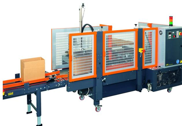
Серия F145 представляет собой автоматические формовщики и заклейщики коробов с производительностью до 12 коробов в минуту производства компании Siat, Италия. Модели данной серии отличаются по размерам коробов, с которыми они работают. Данные машины формируют коробки из стандартных заготовок и заклеивают нижние створки короба лентой скотч. Автоматический формовщик гофрокоробов F145 предназначен для интеграции в высокопроизводительные автоматические упаковочные линии.
