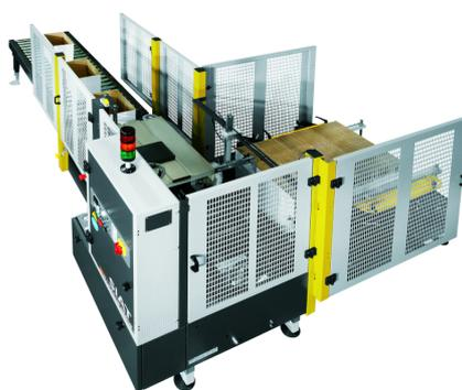
Серия F144-4 представляет собой автоматические формовщики и заклейщики коробов с производительностью до 12 коробов в минуту производства компании Siat, Италия. Модели данной серии отличаются по размерам коробов, с которыми они работают. Данные машины формируют коробки из стандартных заготовок и заклеивают нижние створки короба лентой скотч. Автоматический формовщик гофрокоробов F144-4 предназначен для интеграции в высокопроизводительные автоматические упаковочные линии.
