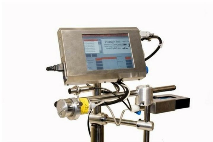
Модель ProDigit 106 представляет собой крупносимвольный каплеструйный маркировщик производства компании MapleJet, Канада, который обеспечивает капельно-импульсную струйную печать высокого разрешения шириной до 106 мм на пористых и непористых поверхностях. Управление маркировщиком осуществляется контролером ProDigit, который позволяет создавать, сохранять и печатать текст через панель управления с сенсорным ЖКД дисплеем.
