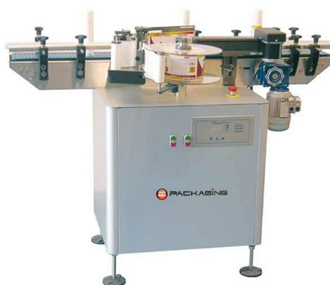
Модель SATURNO 1/T COMPACT представляет собой автоматический аппликатор этикеток с прикатыванием для маркировки продукции цилиндрической формы. Производство компании E-Packaging srl, Италия. Конструкция машины включает этикетировочную головку, конвейер фиксированной скорости 25 м/мин. и компактную основу из алюминия и нержавеющей стали. Головка аппликатора крепится на стойку корпуса и регулируется по вертикали и горизонтали.
