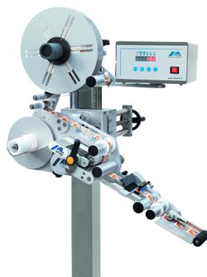
Серия ALstep включает автоматические компактные аппликаторы самоклеющихся этикеток бюджетной ценовой категории. Производство компании Altech s.r.l., Италия. Этикетировочные головки ALstep легко интегрируются в существующие упаковочные линии; размещены на прочной надежной механической конструкции, которая может устанавливаться даже в ограниченных пространствах.
