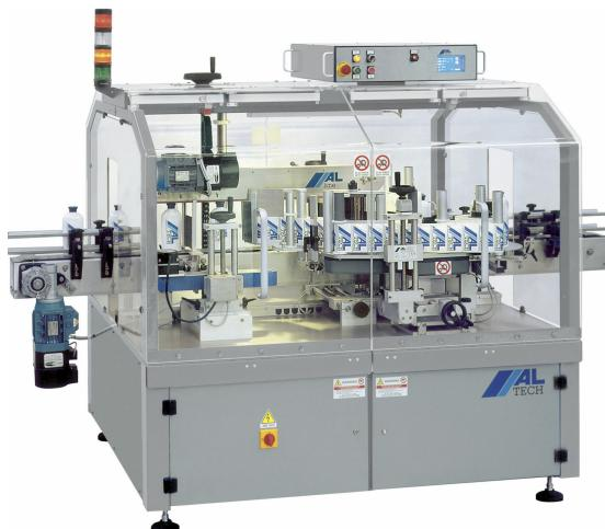
Серия ALLine представляет собой автоматические встраиваемые в линию этикетировочные системы для продукции цилиндрической, эллиптической или прямоугольной формы. Также данные системы могут применяться для продукции нестандартных форм и нанесения рукавной этикетки. Производство компании Altech s.r.l., Италия.
