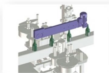
Верхнее прижимное устройство используется для стабилизации неустойчивой продукции при нанесении этикеток и их приглаживания. В конце устройства на входе продукции находится блок безопасности: механический датчик останавливает работу прижимного устройства и системы при помехах в работе устройства. Прижимное устройство оснащено приводами с регулируемой скоростью.
