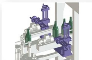
Группа регулировки делителя в горизонтальной и вертикальной плоскости состоит из двойной опоры с трубчатыми регулировочными группами с миллиметровой шкалой, регулировку делителя в вертикальном и горизонтальном положении (для установки делителя по отношению к продукту) с маховиками. Положение делителя изменяется посредством винтов с метрической резьбой.
