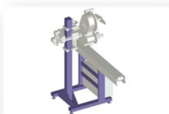
Данная рама используется в этикетировочной системе LIGHT и служит для установки вертикальных или горизонтальных аппликаторов. Рама LIGHT покрыта черной порошковой краской. Конструкция рамы включает вертикальную стойку, H-образную опору, 2 стойки для транспортера и панели управления.: от 850 мм до 1050 мм.
