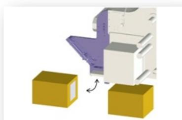
PVT 105 представляет собой узел высокой точности для нанесения этикеток с длинным рычагом, предназначенный для принтера-аппликатора LINERPLUS производства компании Arca, США.
