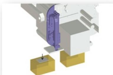
HPS 400 представляет собой узел высокой точности для нанесения этикеток, предназначенный для принтера-аппликатора LINERPLUS производства компании Arca, США. Нанесение этикетки осуществляется следующим образом: этикетка размещается на присасывающей пластине, затем пневмоцилиндр выдувает и наносит этикетку на продукт, который либо стоит на месте, либо движется на конвейере.
