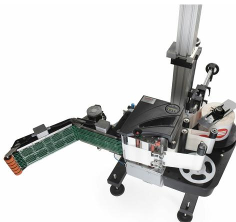
Модель URANO CONCORDE представляет собой пневматическую систему для печати на этикетках и их последующего нанесения на движущиеся коробки. Производство компании E-Packaging srl, Италия.
