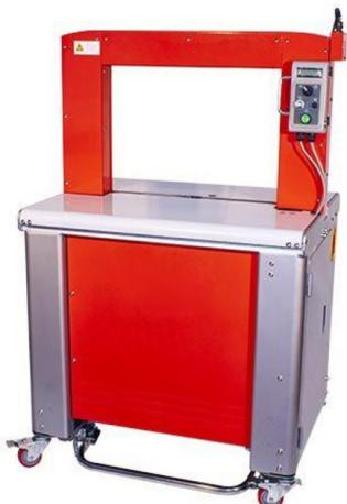
Машина Transpak TP-702RS обеспечивает надежную обвязку пластиковой лентой малой и круглой продукции (пластиковые трубы, стальные стержни). Минимальные размеры упаковки могут составлять до 40мм (W) x 10мм (H) или круглой упаковки диаметром до 32мм x 2шт.
