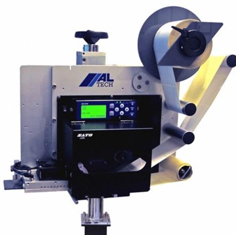
Серия ALcode включает автоматические системы печати и нанесения самоклеющихся этикеток. Производство компании Altech s.r.l., Италия. Данные системы могут быть синхронизированы с компьютером и могут наносить только что напечатанную этикетку как на неподвижную, так движущуюся продукцию.
