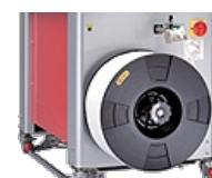
Благодаря специально разработанной удобной конструкции лента автоматически протягивается с верхней части бухты. Таким образом, была устранена необходимость наклоняться, чтобы протянуть ленту.
