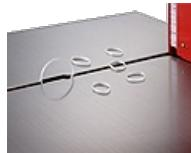
Устройство выброса петли автоматически устраниет ленту, образовывая петлю, если во время обвязки на рабочем столе отсутствовала упаковка. Данная функция помогает сократить время простоя.
