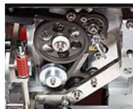
Это — запатентованное новшество Transpak. Крышка стола машины крепится на шарнирах и обеспечивает быстрый доступ к обвязывающей головке для технического обслуживания. Кроме того, направляющие для ПП ленты сконструированы таким образом, чтобы обеспечить максимальную простоту техобслуживания.
