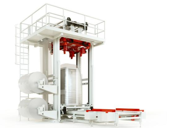
Термоусадочная упаковочная машина для паллет Hooding предназначена для работы с тонкими термоусадочными пленками-рукавами. Машина сокращает количество расходуемой пленки, отрезая нужное количество и сваривая верхушку пленки над грузом, образуя термоусадочный колпак. Процесс опускания пленки на груз сопровождается подачей воздуха, чтобы «раздуть» пленку и не повредить ее о стенки груза.
