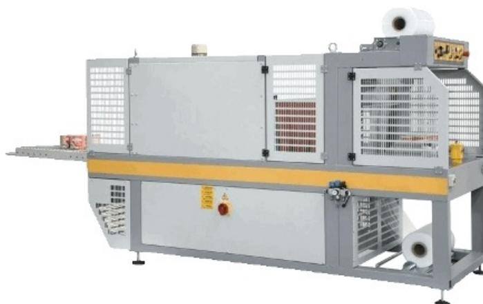
Модель F700 / F700-1 представляет собой полуавтоматическую термоусадочную машину для индивидуальной или групповой упаковки продукции различных видов и форм в ПЭ пленку. Производство компании Siat, Италия. Конструкция данной модели включает блок подачи с пневматическим толкателем, приводной роликовый конвейер и термоусадочный туннель. Термотуннель оснащен внешними регуляторами воздушного потока, стальным сетчатым конвейером и прижимными валиками для приглаживания пленки по бокам продукта.
