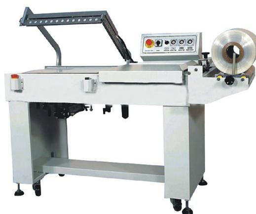
Termoline TL-7555TB — пневматический обрезчик термоупаковочной пленки. Используется в комплексе с туннельными термоусадочными машинами для максимальной производительности. Для обрезки пленки и заварки краев применяется автоматический приводной нож с тефлоновым покрытием, который может работать по таймеру или по нажатию кнопки.
