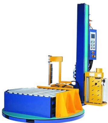
Паллетоупаковщик автоматический стационарный EXP-501A производства Extend Great International Corp. (Тайвань) представляет собой автоматическую машину для упаковки паллет в стрейч(стретч)-пленку, оснащенную роликовым конвейером.
