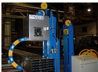
Данная стреппинг-машина разработана таким образом, что может легко выдвигаться из линии для проведения технического обслуживания. Машина может быть зафиксирована на месте установки, и тогда продукция будет продвигаться для обвязки в нескольких местах или же стреппинг-машина может быть установлена сбоку по отношению к упаковываемой продукции, и в таком случае продукция будет находиться в фиксированном положении.
