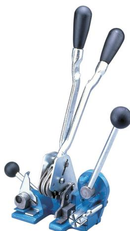
Комбинированное устройство для ПП-ленты Н-42 заменяет собой сразу два ручных стреппинг-инструмента: натяжитель и зажимные клещи. Комбинированному устройству доступны все процессы обвязки: натягивает ПП-ленту, фиксирует с помощью скобы для стреппинга и обрезает лишнюю ленту.
