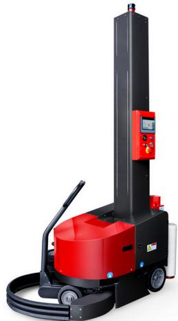
**Мобильный паллетоупаковщик PRIDE 600B** предназначен для закрепления крупногабаритных товаров на паллете и дальнейшей обмотки их в стретч-пленку на предприятиях различных направлений. Модель оснащена панелью управления для настройки параметров обмотки с возможностью сохранения в памяти 3 циклов упаковки.
